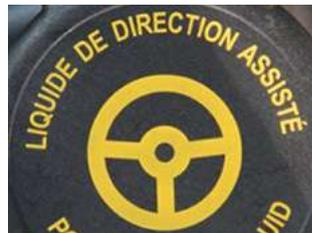
Le remplacement du liquide de direction assistée se fait par aspiration avec une seringue.
