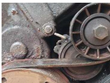
5. Remplacez les pièces : une fois le galet tendeur pigé, il faut retirer la courroie usagée et mettre en place la nouvelle en faisant attention à son sens.
