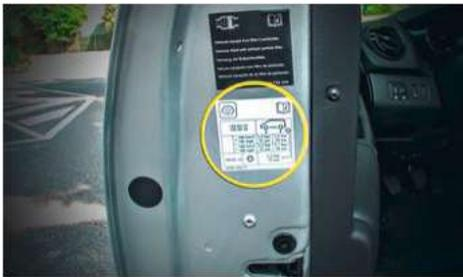
Il faut contrôler les pneus à froid et non à chaud car, si on les contrôle à chaud, l'air est trop dilaté. Il faut idéalement les contrôler une fois par mois.
