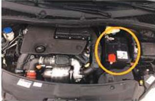
Une batterie est un système de stockage d'électricité : l'énergie chimique stockée dans chaque pile formant la batterie est convertie directement en énergie électrique quand ses bornes sont connectées à un consommateur électrique.
