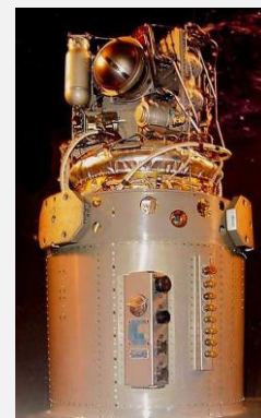
Pile à combustible du module de service
