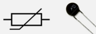
Symbole et photo d'une thermistance
