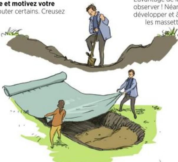
3. Il est temps d'imperméabiliser le fond pour retenir l'eau dans la mare. Si le sol est caillouteux, posez un lit de sable de quelques centimètres. **Puis, posez un feutre géotextile** (de la vieille moquette peut aussi faire l'affaire si elle n'a pas été traitée). Enfin, **amenez la bâche par-dessus et appliquez-la très soigneusement afin qu'elle épouse parfaitement les différents paliers.**
