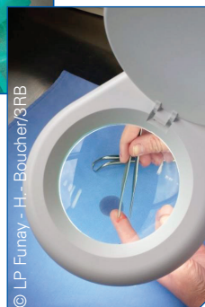
Tests de piquant et de tranchant avec vérification à la loupe
