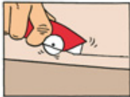
Roulette rentrée, lame sortie
