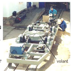
Châssis du petit tramway de Bristol fonctionnant sans caténaire
